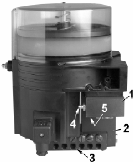
Rys. 1 - Pompa QLS301 z rozdzielaczem zamontowanym pod spodem pompy:
